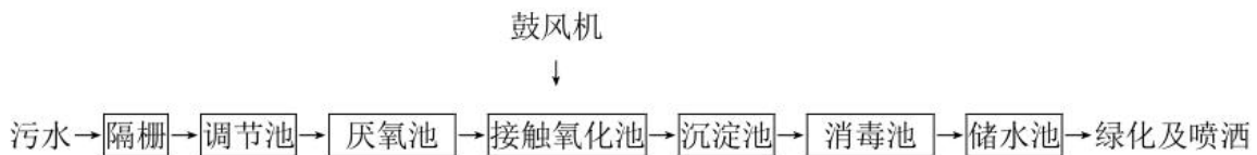
图 2-13 现有生活污水处理站工艺流程
